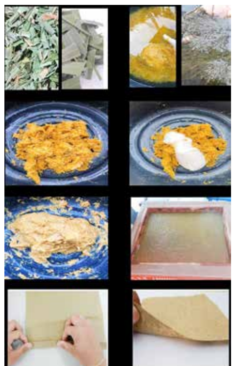
ขั้นตอนการทำแผ่นกรองอากาศจากเส้นใยใบไม้ (ซ้าย) และใบอ้อย (ขวา)
