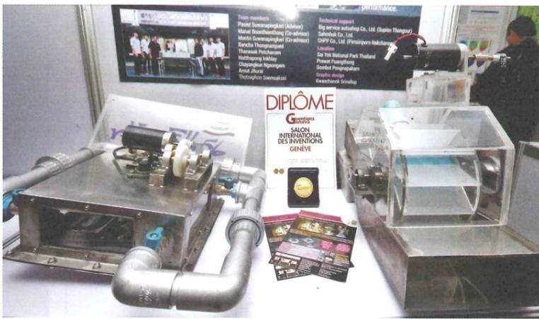
เดินสายไฟฟ้าเข้าพื้นที่ค่อนข้างลำบาก และมีค่าใช้จ่ายสูง ดังนั้นจึงคิดสร้างกังหันน้ำขนาดนาโน ชื่อว่าเอ็นไฮฟอล 56 (hHy-Fall56) ขึ้น เพื่อผลิตไฟฟ้าให้กับชาวบ้านพื้นที่ชุมชนได้มีไฟฟ้าใช้ เพราะเครื่องผลิตกระแสไฟฟ้าส่วนมากมีขนาดใหญ่ซึ่งไม่สะดวกในการขนย้ายและติดตั้งยาก จากการศึกษาได้เลือกพื้นที่ชุมชนเมืองกาญจนบุรีโดยเข้าไปศึกษาที่อุทยานแห่งชาติน้ำตกไทรโยคใหญ่ ทั้งนี้ขั้นตอนการวิจัยได้วิเคราะห์ปัญหาสภาพพื้นที่ สภาพแหล่งน้ำ ความสูงของระดับน้ำเพื่อมองหารูปแบบของกังหันน้ำที่เหมาะสม โดยกังหันเพลตัน
